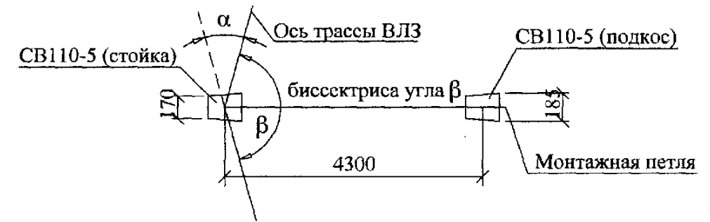
Схема установки стойки и подкоса
